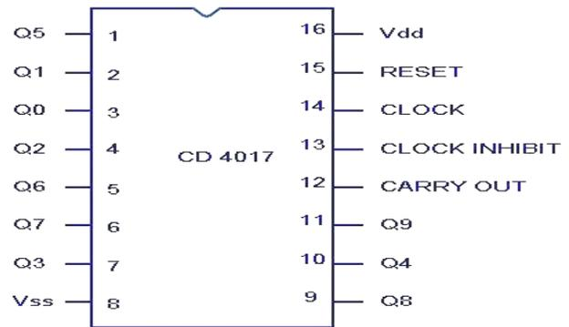
Fig. 3. 4017-pin-diagram
